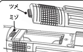
「電池カバー」をもとに戻す際には、本体のミゾに「電池カバー」のツメを差し込んでから、ネジをしめます。
