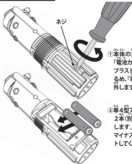
①本体の左側面にある「電池カバー」のネジをプラスドライバーでゆるめ、「電池カバー」を外します。
