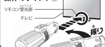
ボタンを押しながら本体を振り、正面で止める際に、本製品の「赤外線受発光部」が操作したい家電製品の『リモコン受光部』に向くようにします。
